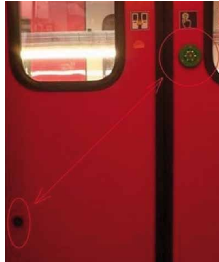
B16 ÜG_FUNKTION_Tür mechanisch aber nicht elektrisch verriegelt
