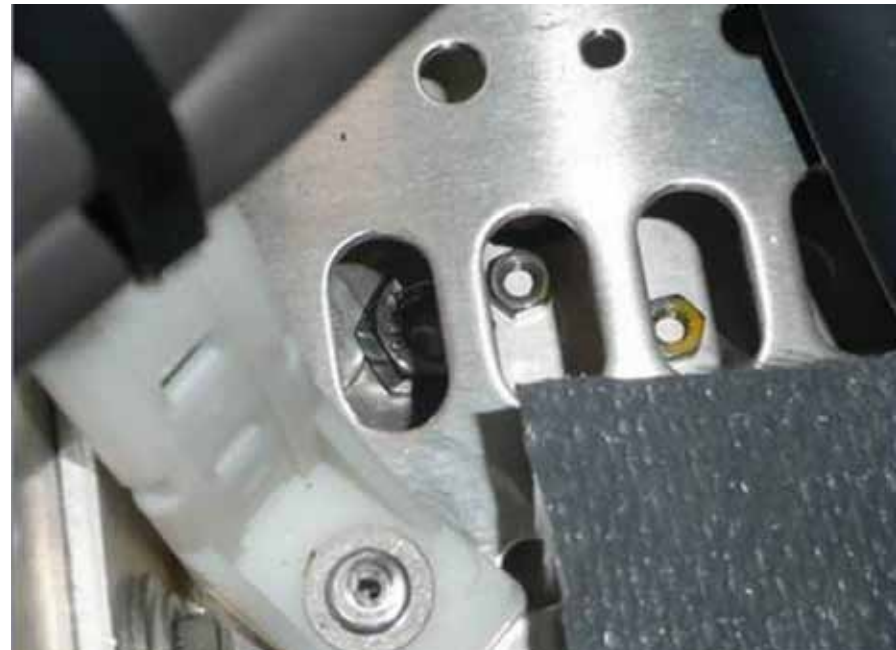
B12 STROMRICHTER_metalli sehe Fremdkörper im Umrichter
