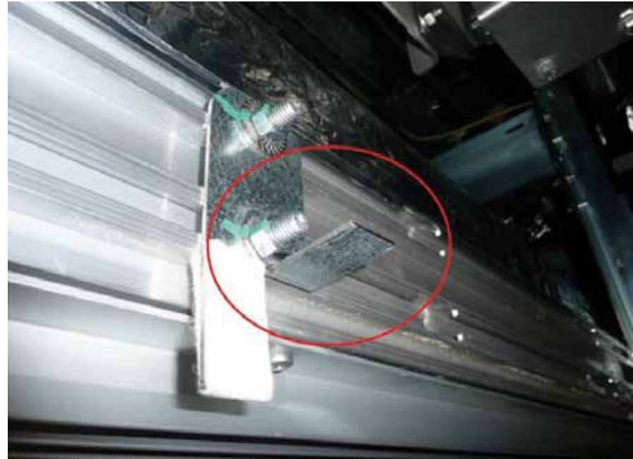
B18 ÜG_MONTAGE_Winkel scharfkantig_Verletzungsgefahr
