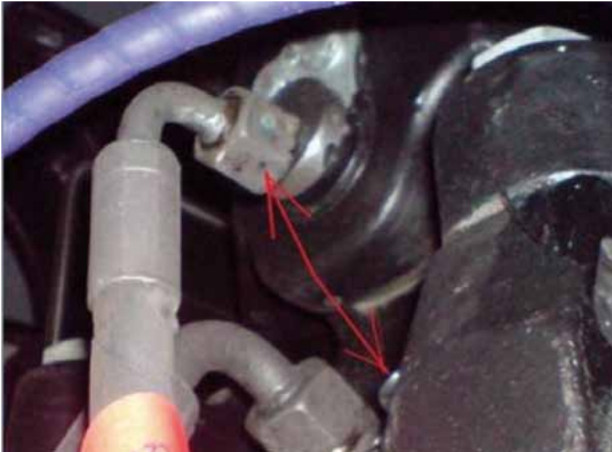
B9 DREHGESTELL_Luftanschluss Bremszylinder nicht angeschlossen
