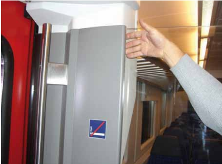
B15 ÜG_MONTAGE_Spalt an Verkleidungselement
