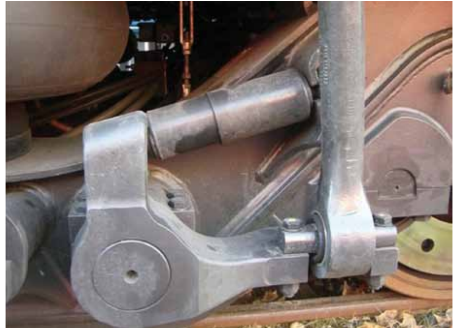
B8 ÜG _ROHR_DICHT _Dämpfer undicht
