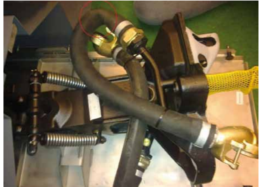
B10 DREHGESTELL_Luftschlauch geknickt_ Querschnittsverminderung
