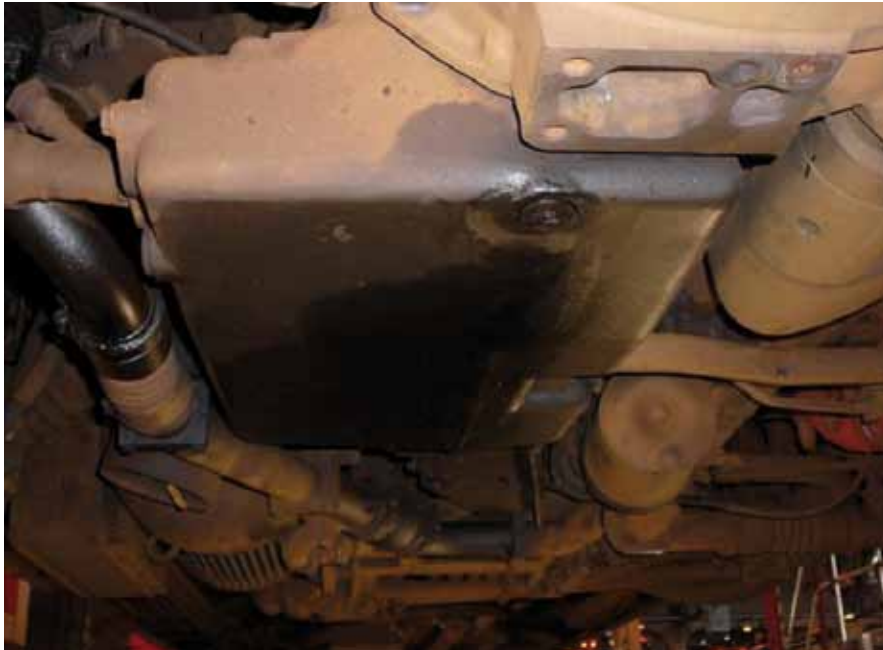
B21 ÜG_ROHR_DICHT_Undichtigkeit Ölwanne
